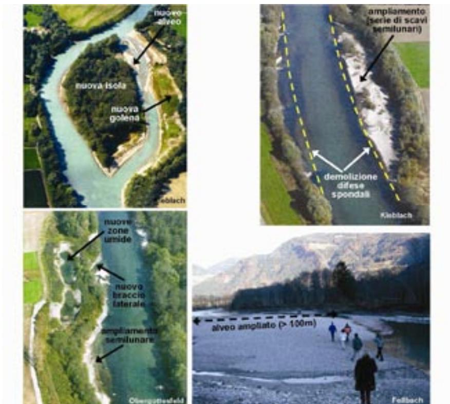
Fig. 4.14. Esempi di interventi attuati sulla Drava austriaca per contrastare l'incisione dell'alveo: demolizione delle difese spondali in massi e scavo di lembi semilunari di nuova piana inondabile, alvei secondari (con formazione di isole fluviali), bracci laterali e zone umide perifluviali.
