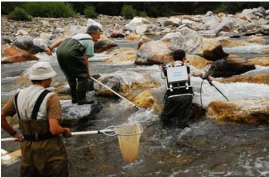
*Fig. 8.3 - Esempio di campionamento di ittiofauna con elettroscorditore spallabile a batteria.*
