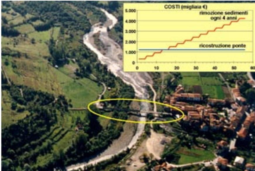
*Fig. 4.11 - Tradizionalmente, nel caso di luce insufficiente di un ponte (nell'ovale), si asportano sedimenti. Il costo dell'intervento, ripetuto negli anni, a lungo termine supera quello della ricostruzione del ponte con arcate più alte e meno piloni in alveo.*
